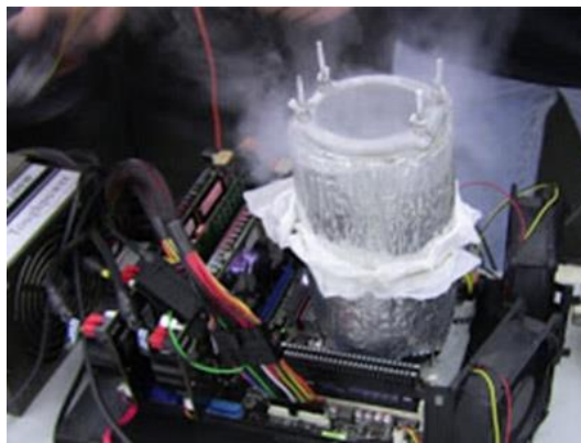
Gambar 29. Dry Ice Cooler dan Nitrogen cair
